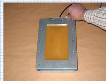
Application du vide sous la cloche d'aspiration
