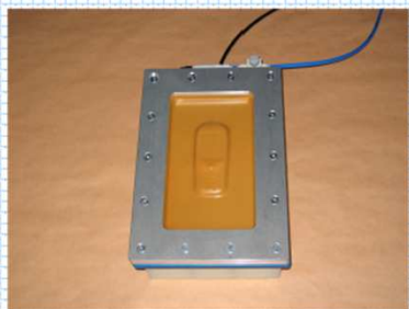
Lorsque le vide est obtenu sous la cloche d'aspiration, activer le vide à l'aide de la pédale de commande
